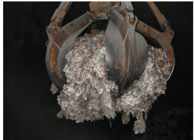
Ein Greifer befördert die Banknoten in den Verbrennungsofen.
