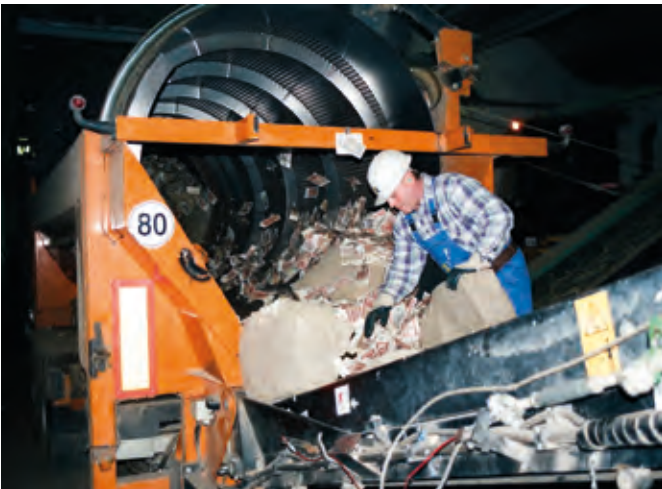
Die Scheine werden in einem Trommelsieb von Steinen und Sand getrennt.
